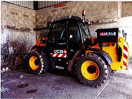
Le chargeur est équipé d'un filtre BMAIR qui permet de protéger l'habitacle de toute entrée de poussière dangereuse pour la santé. Pour son bon fonctionnement l'étanchéité de la cabine doit être maintenue en parfait état.
